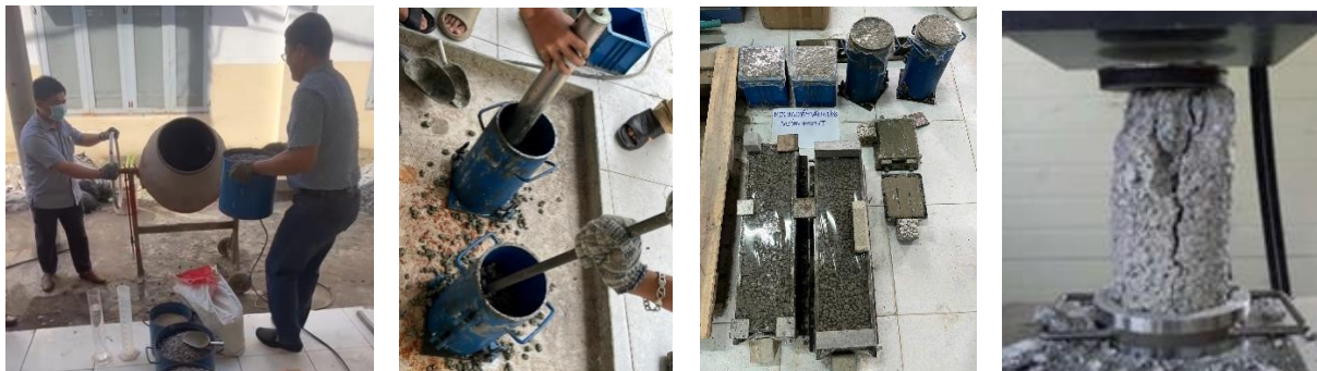
Hình 7. Quy trình trộn bê tông rỗng, đúc mẫu hình trụ tiêu chuẩn và thí nghiệm phá hủy nén mẫu bê tông rỗng.
