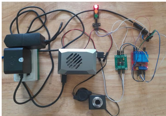
Hình 8. Mô hình hệ thống nhận diện xe cứu thương và điều khiển đèn giao thông.
