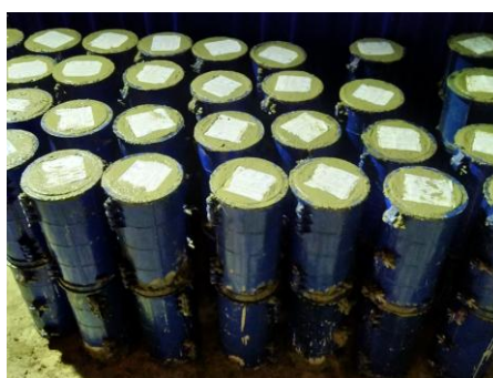
Hình 4. Mẫu bê tông Geopolymer sau khi đúc mẫu.
