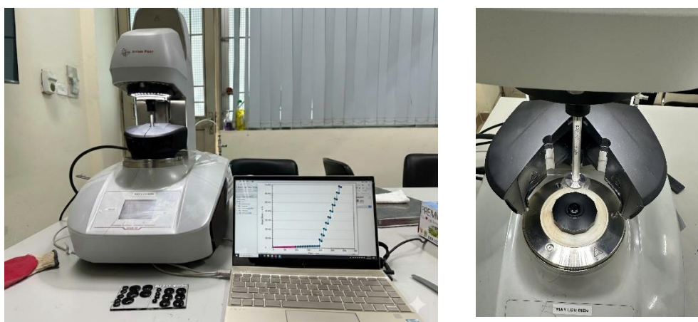
Hình 3. Thiết bị SmartPave 92 sử dụng cho thí nghiệm MSCR.
