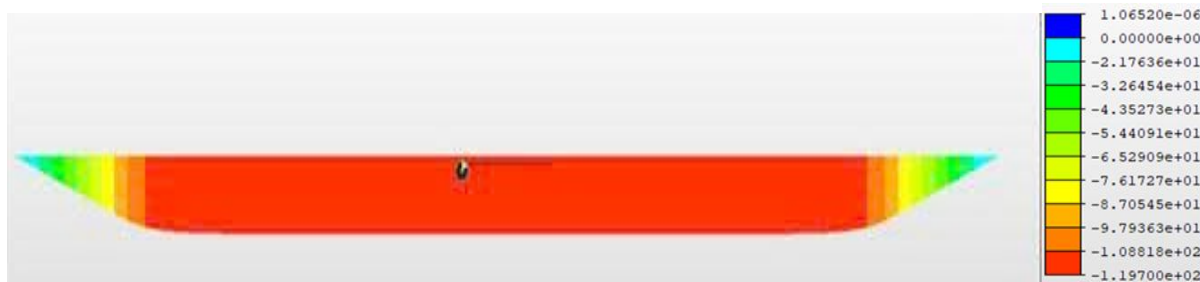
Hình 5. Ứng suất dọc trong ray do tải trọng nhiệt độ trong ray ( lớn nhất = -119,7 MPa; nhỏ nhất = 0,0106 MPa).
