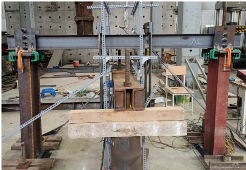
Hình 7. Bố trí thí nghiệm uốn bốn điểm cho mẫu dầm A1.
