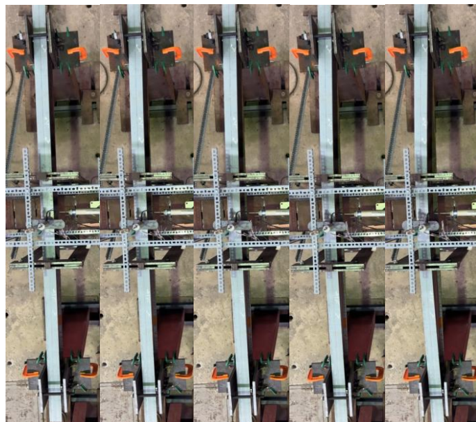
Hình 8. Diễn biến biến dạng và cơ chế mất ổn định dầm A1, A2 và A3 trong thí nghiệm uốn bốn điểm.
