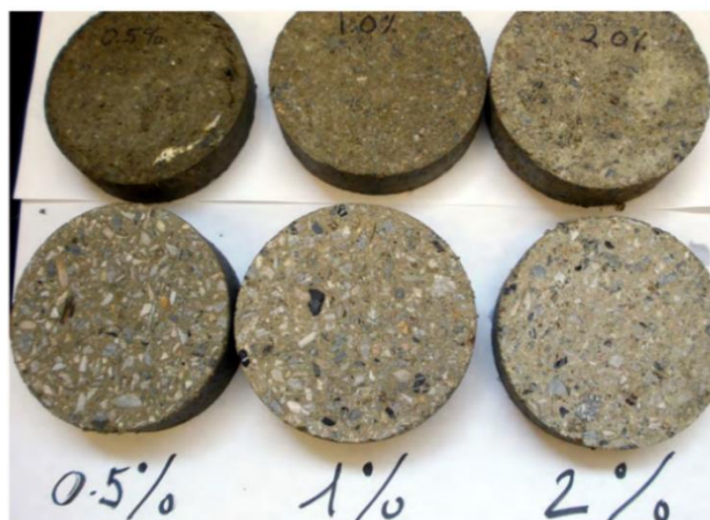
Hình 1. Vật liệu bê tông nhựa sáng màu sử dụng phụ gia Titanium Dioxide ( \text{TiO}_2 ) [6].
