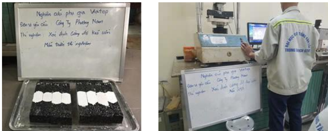
Hình 12. Thử nghiệm đánh giá cường độ chịu kéo khi uốn.
