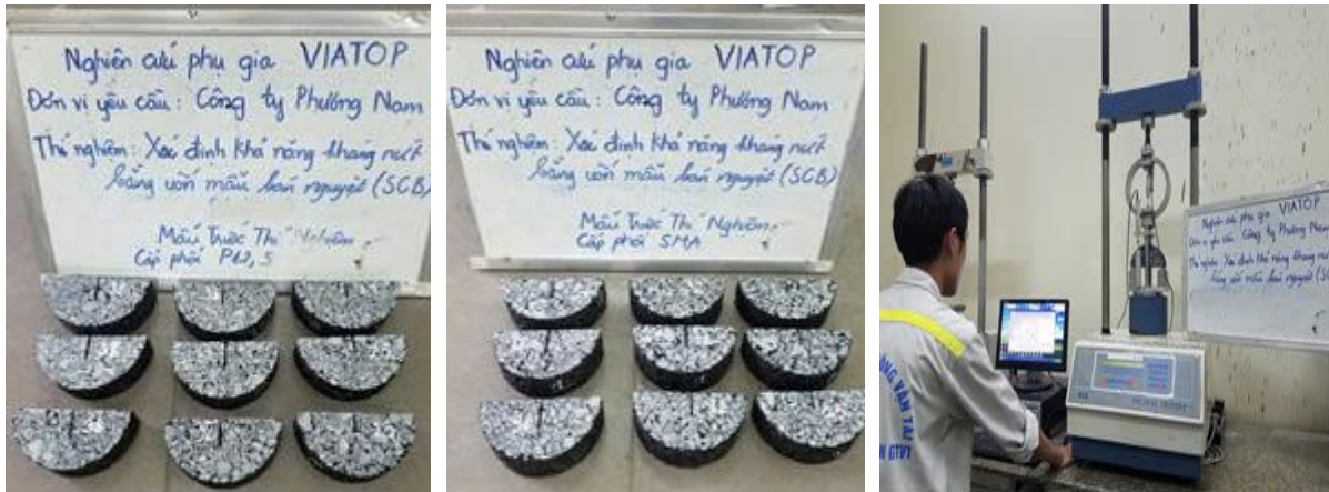
Hình 14. Xác định độ bền nứt bằng mẫu dầm bán nguyệt (SCB test).
