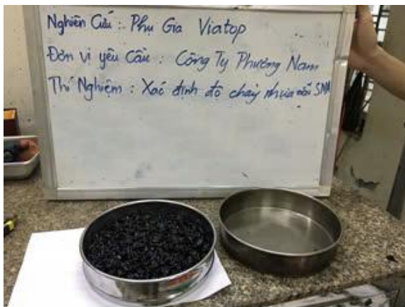
Hình 5. Thí nghiệm xác định độ chảy nhựa.
