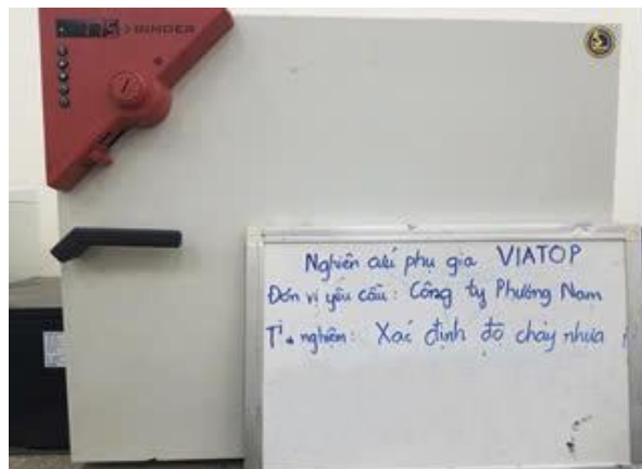
Hình 5. Thí nghiệm xác định độ chảy nhựa.
