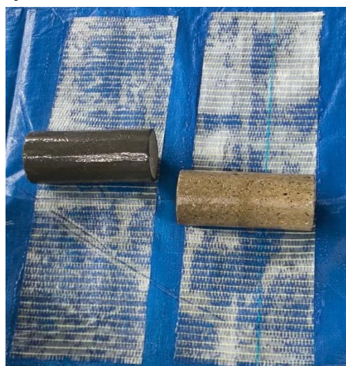
a) Công tác quét keo epoxy lên tấm sợi
