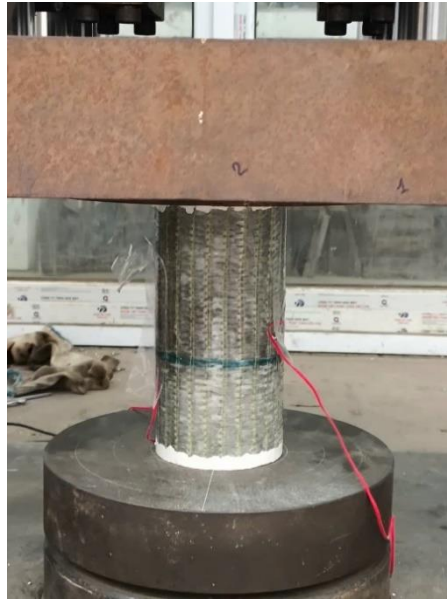
Hình 2. Mẫu thí nghiệm ở máy nén SANS-3000 kN.
