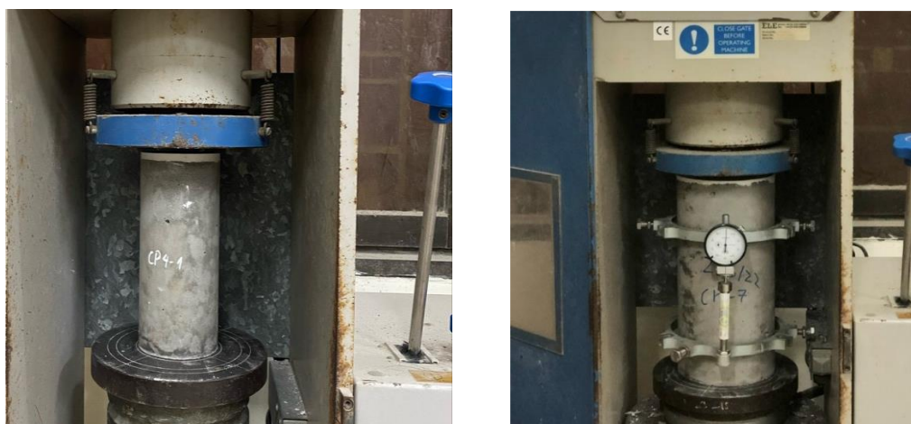
Hình 1. Thí nghiệm xác định cường độ chịu nén (trái) và mô đun đàn hồi (phải) bê tông geopolyme.
