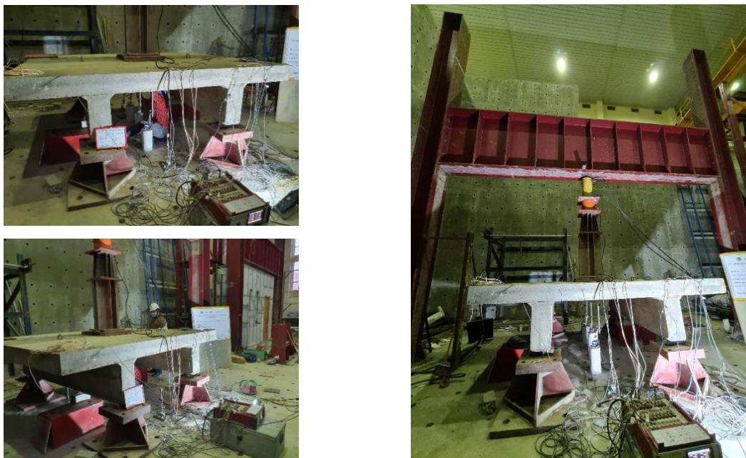
Hình 4. Bố trí thí nghiệm nén mẫu bản mặt cầu.
