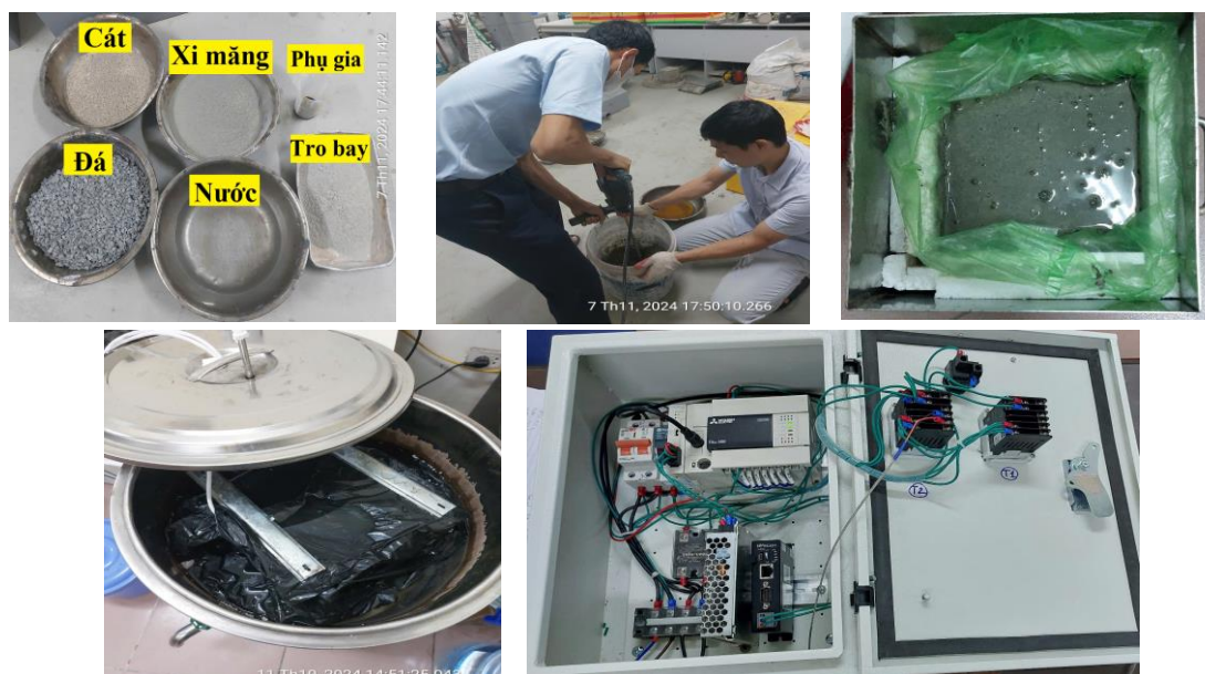
Hình 8. Công tác chuẩn bị, trộn mẫu thí nghiệm.
