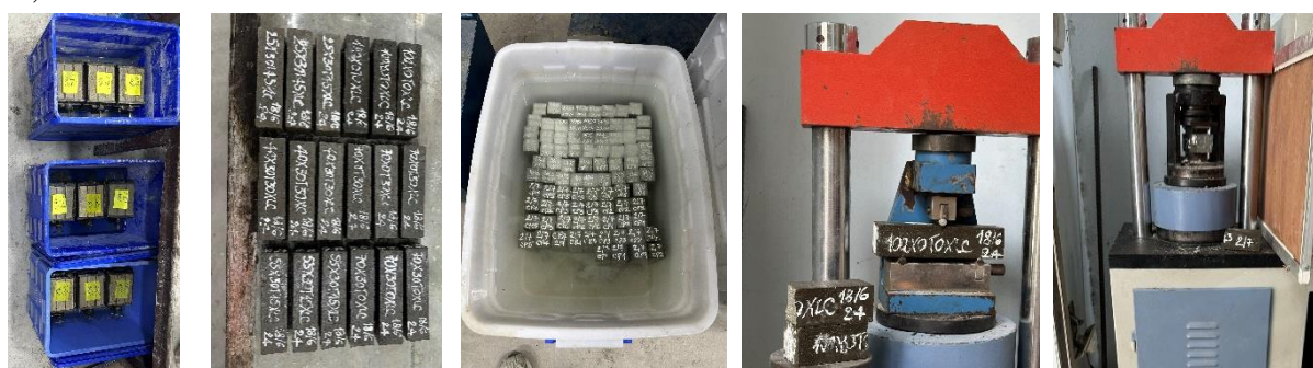
Hình 6. Một số bước bảo dưỡng và thử nghiệm mẫu 40 \times 40 \times 160 \text{ mm} .
