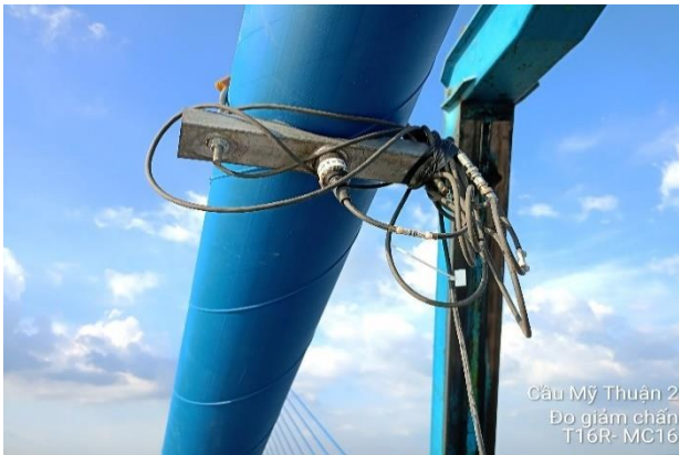
Hình 10. Cảm biến thu thập dữ liệu dao động (Hình ảnh được chụp bởi tác giả vào 17/12/2023).
