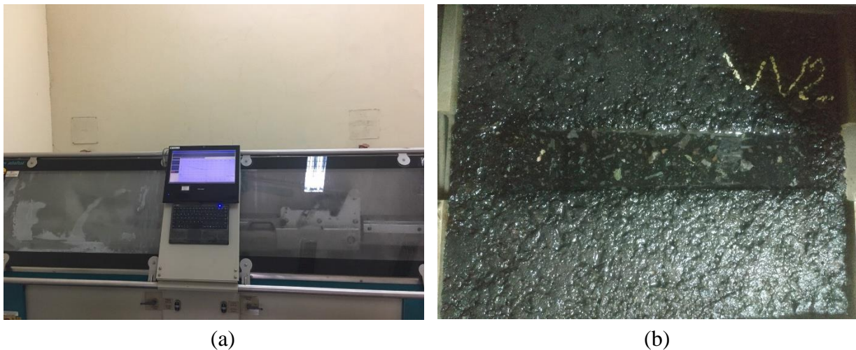
Hình 4. Thí nghiệm HWTT: (a) thiết bị thí nghiệm HWTT, (b) mẫu sau khi thí nghiệm.
