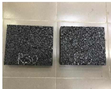
(b) Mẫu thí nghiệm hằn lún vệt bánh xe
