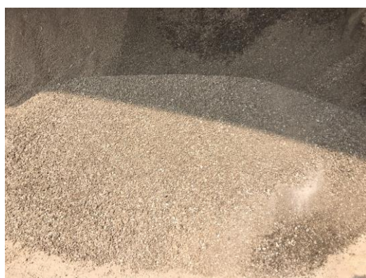
(a) RAP chứa tại trạm
