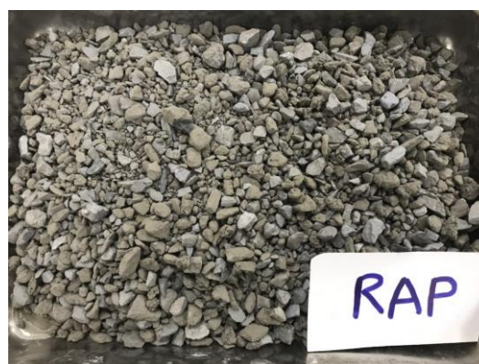
(b) RAP được chuẩn bị ở phòng thí nghiệm
