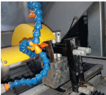
Hình 7. Quá trình cắt mẫu.
