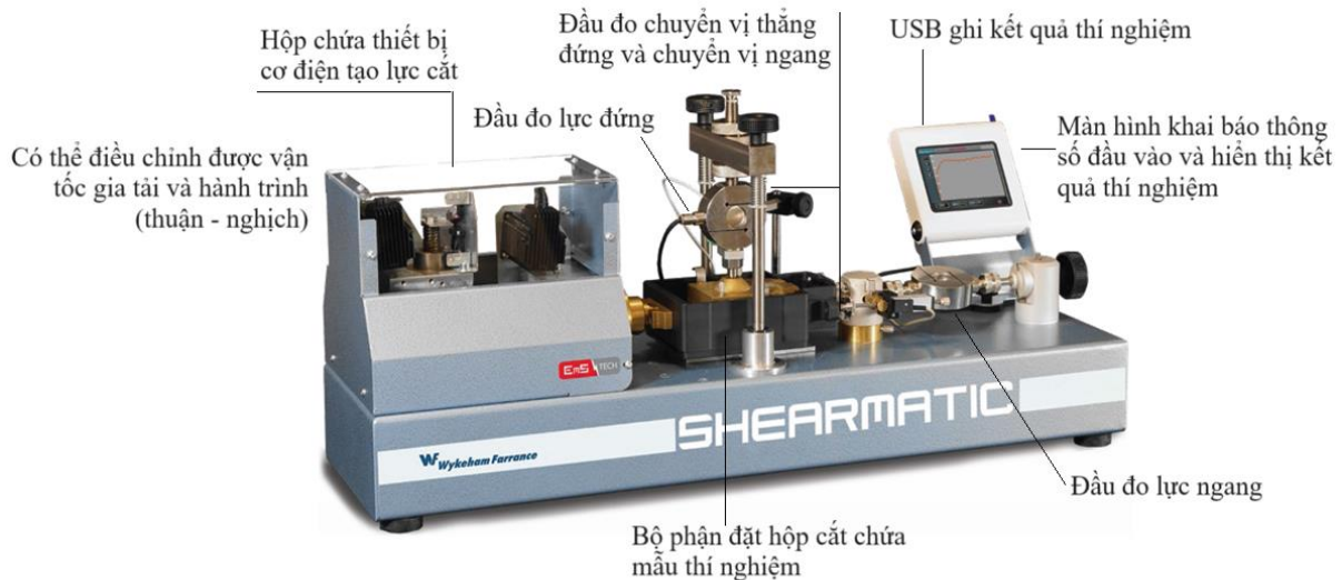
Hình 4. Các bộ phận chính máy cắt phẳng kỹ thuật số tự động Shearmatic (xuất xứ Italia).
