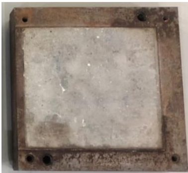
Hình 9. Mẫu bê tông được đưa vào thớt dưới đã chế tạo.
