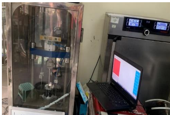
Hình 5. Thí nghiệm Mô đun đàn hồi tĩnh.
