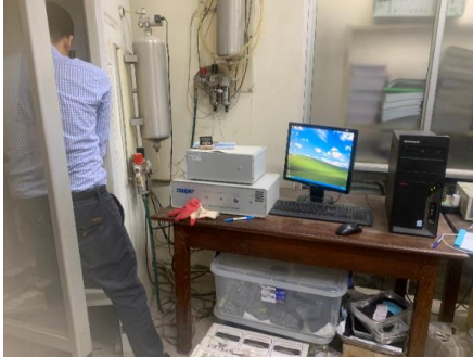
Hình 7. Thí nghiệm xác định mô đun đàn hồi động trên thiết bị Cooper.
