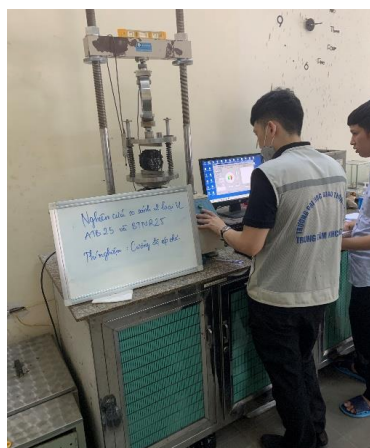
Hình 6. Thí nghiệm xác định cường độ chịu kéo gián tiếp.
