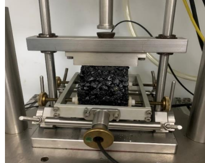
Hình 7. Thí nghiệm xác định mô đun đàn hồi động trên thiết bị Cooper.
