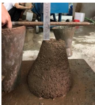
Hình 5. Thí nghiệm xác định độ sụt của hỗn hợp bê tông đất sau khi trộn.
