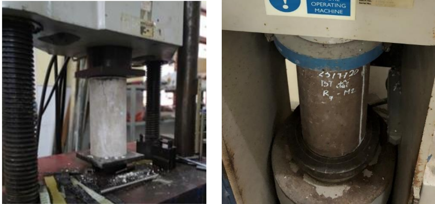
Hình 7. Thí nghiệm xác định cường độ chịu nén của các mẫu bê tông đất.
